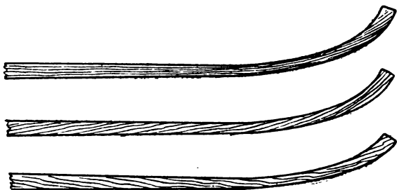
Рис. 154. Направление слоев древесины: вверху —продольное расположение слоев; в центре —слои скошены по ходу; внизу —слои скошены против хода.
