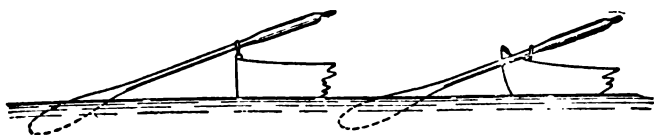
Рис. 103. Уключина для рулевого весла.
